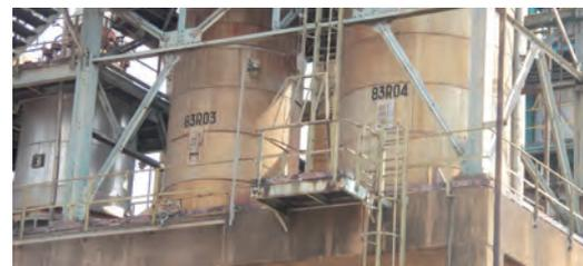
Les catalyseurs du Laboratoire/Analyseurs ont subi une cure de jouvence en janvier dernier. Cette régénération a consisté à éliminer les cokes qui s'y étaient encastrés pendant le processus de fabrication et à réactiver ces catalyseurs afin de leur redonner leurs spécifications. Elle s'est déroulée en quatre phases : l'arrêt, la recherche d'hydrocarbure, la régénération et le redémarrage.
